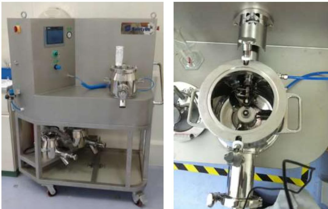
Imagen 3 y 4. Granulado en el equipo *high shear* y tamizado del mismo.
